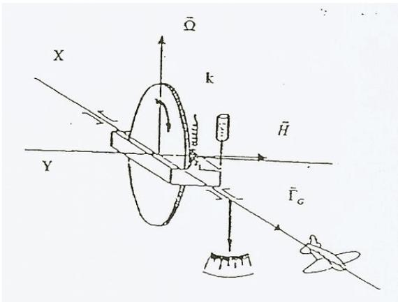
A l'équilibre des deux moments le cadre du gyromètre aura tourné d'un angle  $\theta$  par rapport à la position initiale horizontale:
