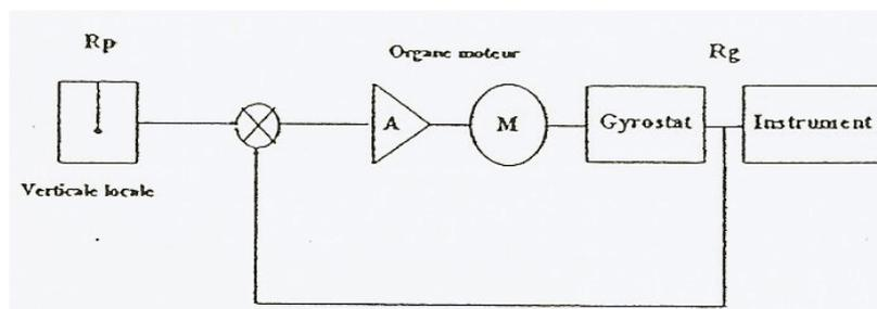
Tout mouvement de l'avion autour de ses axes de roulis et tangage se traduira sur l'horizon artificiel par un déplacement de la sphère par rapport au symbole représentant l'avion.
