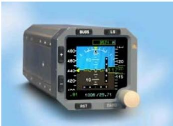
Il s'agit L'ISIS est conçu pour mesurer et afficher les informations de réserve de tangage et de roulis, l'altitude et la vitesse relative. Sa fonction secondaire lui permet d'afficher une déviation en approche ainsi que le cap.
