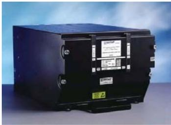
Le SEC est un sous système de l'Electrical Flight Control System (EFCS) qui commande les spoilers et les surfaces contrôlant le tangage. On en compte 3 par avion. Son rôle est de commander les surfaces mobiles en fonction des ordres donnés par le pilote.
