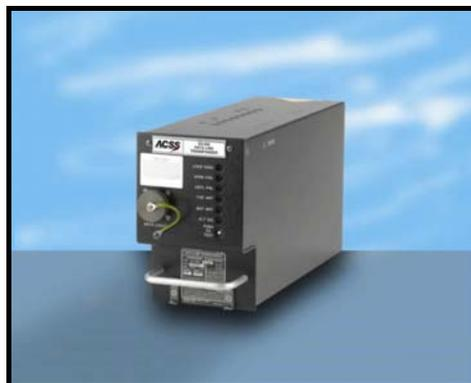
L'ATDL (ATA 34 : Navigation) est le transpondeur du système ATC\*, il y en a deux par avion. Il utilise le mode S qui est une surveillance coopérative et un système de communication pour le contrôle de la navigation aérienne.
