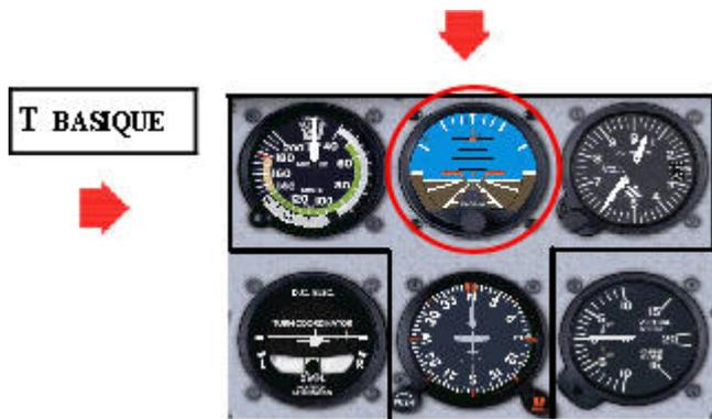
L'horizon artificiel fait partie des instruments de vol primaires qui utilisent des gyroscopes ..
