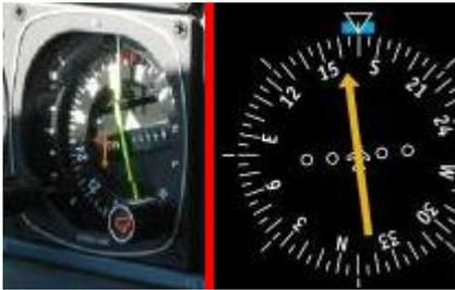
Il s'agit d'un gyroscope à deux degrés de liberté qui permet de conserver une référence de cap de façon beaucoup plus précise qu'un compas magnétique. Il est asservi à une vanne de flux qui permet de le recalibrer automatiquement en fonction du champ magnétique terrestre. Il est aussi appelé *plateau de route*.
