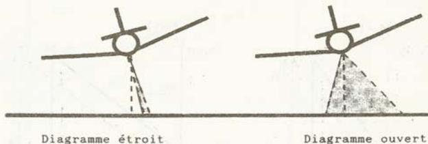
Dans ce dernier cas, l'antenne de réception captera différents échos, ce qui se traduit par un élargissement du spectre de fréquences vers les fréquences élevées.
