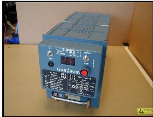
Le BSCU (ATA 32 : Landing gear) réalise la gestion du freinage, pour permettre, quelque soit les conditions climatiques, d'assurer un bon contact du pneu sur la piste lors du décollage et de l'atterrissage.
