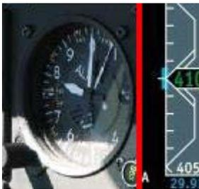
C'est un [baromètre](#) étalonné en fonction d'une atmosphère standard [Atmosphère type OACI](#) qui convertit une pression statique en altitude (généralement mesurée en pieds).
