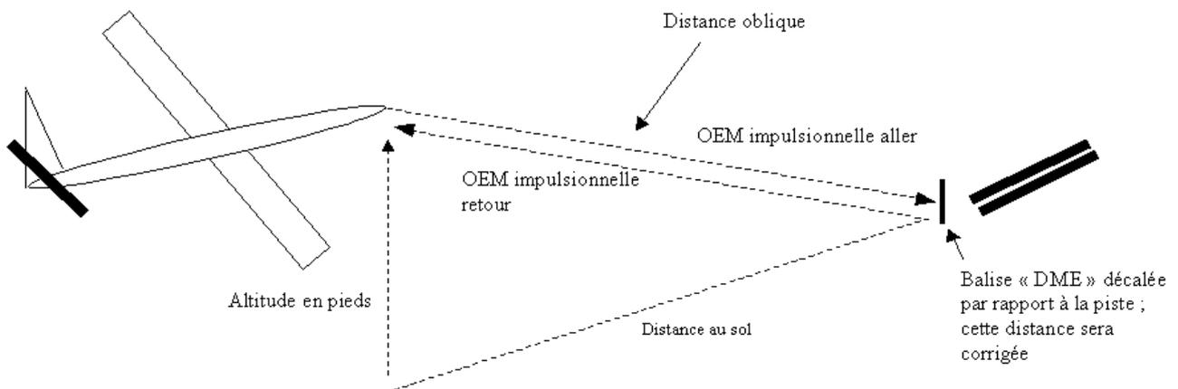
Les OEM d'interrogation (aller) et de retour sont décalées de 63 MHz ; deux canaux sont donc nécessaires pour assurer la communication entre l'aéronef et la balise DME ; la bande de fréquences DME est 960MHz – 1215MHz ; les canaux sont espacés de 1MHz ; la mesure de la distance oblique se fait par la mesure du temps écoulé entre le moment où l'avion émet une impulsion et l'instant où il reçoit le retour de la balise au sol.
