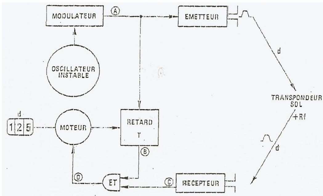
L'avion est équipé d'un émetteur d'interrogation qui envoie des impulsions dans toutes les directions. Ces impulsions sont captées et amplifiées par une station au sol qui les retransmet en omnidirectionnelle avec un retard de 50 $\mu$ s.
