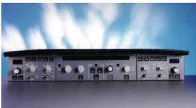
Le FCU permet aux pilotes d'imposer des paramètres de vol au pilote automatique (vitesse, altitude...).
