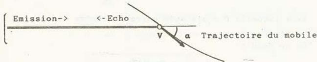
La fréquence reçue  $F_r$  est différente de la fréquence émise  $F_e$
