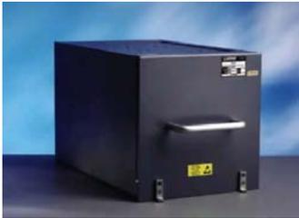
Ce calculateur contrôle les ailerons et la gouverne de profondeur par l'intermédiaire de servo-commande. Il y en a 2 par avion.
