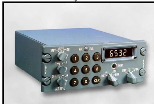
L'ATC CP (ATA 34 : Navigation) est le panneau de commande dans le cockpit qui contrôle le TCAS. Il est généralement monté sur le piédestal ou sur l'overhead panel.
