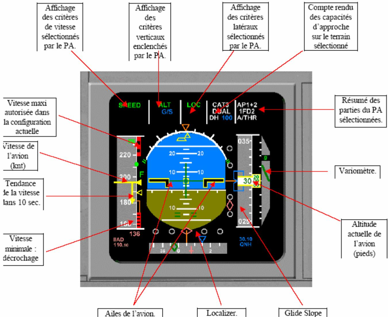
Le PFD (**Primary Flight Display** ou **indicateur principal de vol**) indique l'attitude de l'appareil ainsi que sa vitesse. Le sol est représenté par une partie verte et le ciel de couleur bleu. Les chiffres apparaissant sur la partie bleu et la partie verte ( -10 , 0 , 10 , 20 ) correspondent à l'assiette en degrés.
