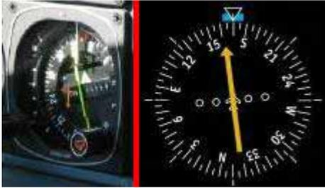
Il s'agit d'un gyroscope à deux degrés de liberté qui permet de conserver une référence de cap de façon beaucoup plus précise qu'un compas magnétique. Il est asservi à une vanne de flux qui permet de le recalibrer automatiquement en fonction du champ magnétique terrestre. Il est aussi appelé *plateau de route*.
