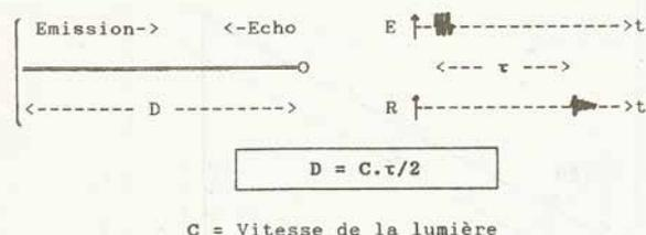
Ces radars ne permettent pas de mesurer des distances faibles. En pratique il faut  $D > 5 m$ .
