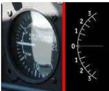
Dans sa version classique, cet instrument utilise les variations de *pression statique* pour indiquer des variations d'altitude, c'est-à-dire des vitesses verticales. D'autres réalisations utilisent les variations d'énergie totale de l'avion pour indiquer la vitesse verticale de celui-ci. À noter qu'il fonctionne avec un léger temps de retard, dû à sa méthode de fonctionnement.
