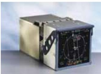
Ces écrans font partis de l'EIS2 (Electronic Instrument System 2<sup>ème</sup> génération) qui est le système d'affichage des informations sur les écrans composant l'EFIS (Electronic Flight Instrument System) et l'ECAM.
