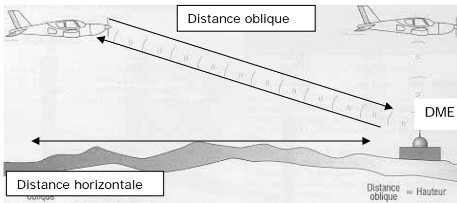
Le DME est un ensemble comprenant un élément interrogateur embarqué et, au sol, un élément répondeur, « une balise », généralement associé à un VOR ou à un ILS. Il donne une information de distance oblique (et non pas de distance réelle) en milles nautiques (NM) par rapport à la balise au sol
