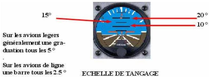
Le gyroscope de l'horizon artificiel sur la plupart des avions légers peut se renverser à partir d'un angle de tangage de +/- 70° degrés ou si l'angle d'inclinaison latérale dépasse 100° degrés
