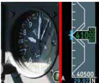
C'est un baromètre étalonné en fonction d'une atmosphère standard Atmosphère type OACI qui convertit une pression statique en altitude (généralement mesurée en pieds).
