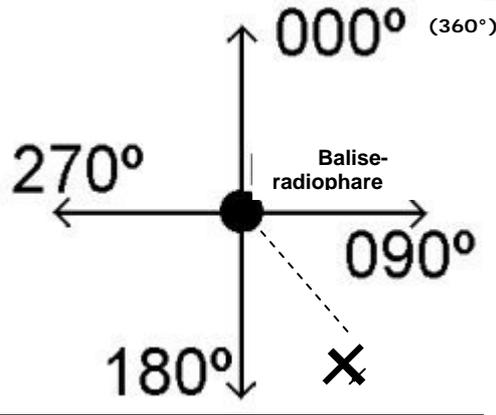
La balise est omnidirectionnelle ; elle émet sur 360° ; elle transmet à l'avion l'azimut (angle formé entre le nord magnétique (0°) et la droite reliant la balise à l'avion, ex. : 135° sur la figure ci-contre). Chaque piste possède une caractéristique en azimut : il suffit donc à l'avion de s'aligner sur celui-ci.
