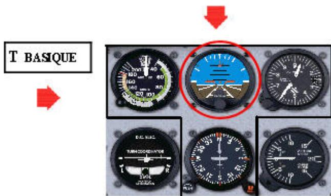
L'horizon artificiel fait partie des instruments de vol primaires qui utilisent des gyroscopes ..
