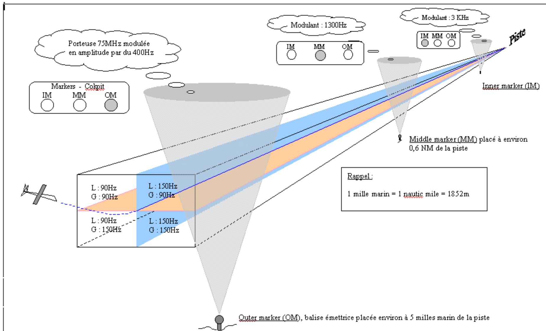
Figure 3 : balises de positionnement (markers)
