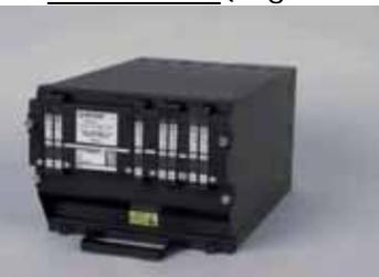
Le FMGEC appartient au FMGES (Flight Management, Guidance and Envelope System) qui comprend également le FCU et les MCDUs (Multipurpose Control and Display Unit).
