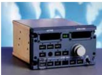
Les RMP permettent de choisir les fréquences de radio communication. Ils servent aussi de secours (Back-up) pour remplacer le FMGC (Flight Management and Guidance Computers) pour la commande des fréquences de radio-navigation (VOR, DME, ILS, ADF).
