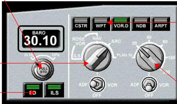
Flight Management Panel (FMP) permettant de sélectionner les éléments à visualiser sur le PFD et le ND
