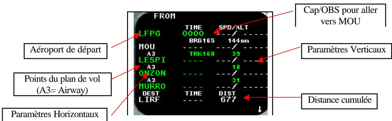
Il est maintenant temps de programmer l'arrivée. Pour cela Il faut accéder à la sous partie de l'aéroport de destination en pressant le LSK contigu à celui-ci.
