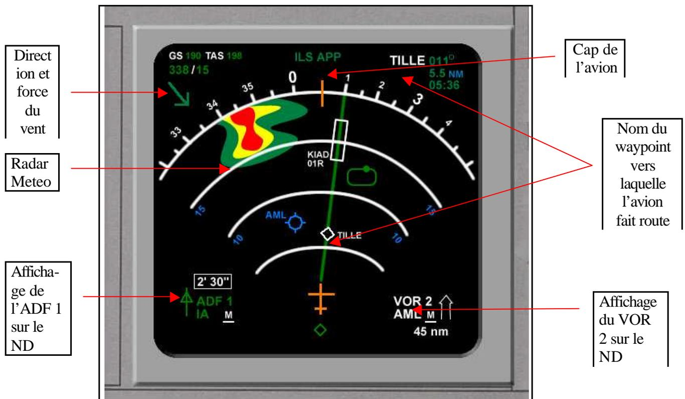
Le ND en mode Arc permet d'afficher la route verticalement en ne prenant en compte que le reste de la trajectoire à parcourir. L'avion est constamment au bas de la fenêtre et la route face à lui. C'est le mode le plus utilisé en croisière, car il est facile à visualiser et comprend seulement les points à parcourir.
