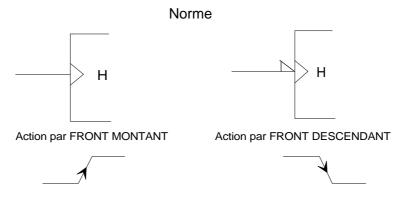
*EN DEUX TEMPS*: Une période interne complète est nécessaire, le front d'entrée est décomposé de façon interne en un front montant et un front descendant (c'est le cas des bascules maître-esclave)
