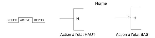
**PAR FRONT**: La commande n'a lieu que lors de la transition d'un état 0 à 1 (cas d'une commande sur front positif ou montant) ou bien lors de la transition 1 à 0 (cas d'une commande sur front négatif ou descendant).La durée de la commande est alors très courte.
