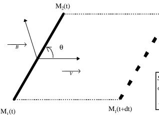
Si on considère, pendant la durée dt, le mouvement de translation dans un champ d'induction  $\xrightarrow{B}$  d'un segment conducteur  $M_1M_2$  de longueur l faisant un angle  $\theta$  avec sa vitesse  $\xrightarrow{V}$ , on peut écrire :
